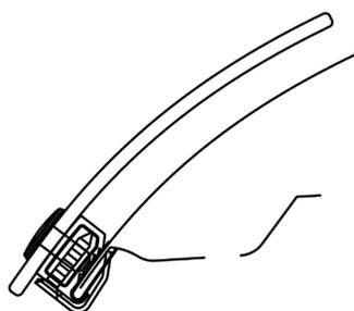
15. Épluchez et pliez deux (2) des garnitures antiabrasion de film dans la moitié au-dessus du bord de capot aligné avec les trous intérieurs du protecteur dans le secteur au-dessus des phares.
