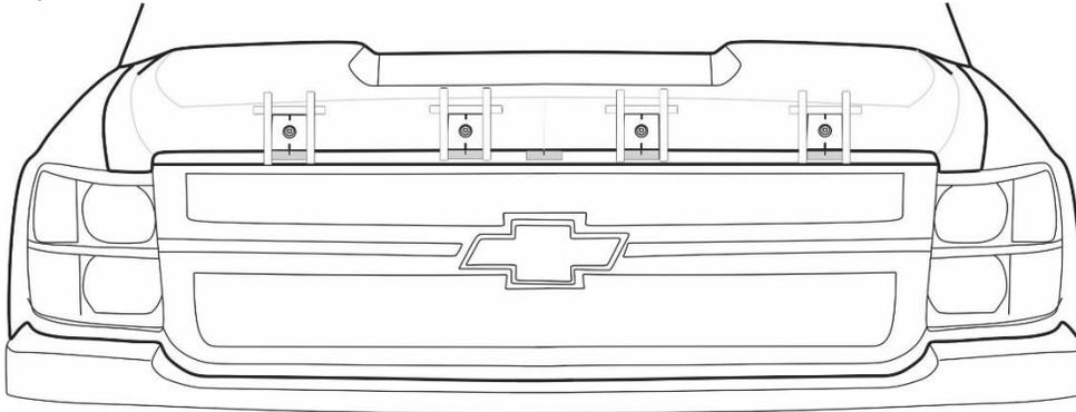
7. Retirer la pellicule de protection du bas du socle et d'adhérer à la surface du capot en communiquant avec le bord d'attaque du piédestal avec son emplacement à l'arrière de l'encadrement de grill et de rotation en place sur la surface du capot. «Humide de» surface du socle pour assurer un contact complet de l'adhésif avec la surface de la hotte. **Voir l'illustration.**
