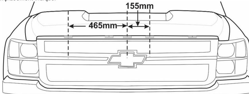
4. Installez les chevilles carrées dans le haut des socles adhésives. Utilisez l'encoche de centrage sur les piédestaux pour aligner son emplacement avec la marque de crayon sur la bande de l'étape précédente. **Remarque:** Lorsque situé correctement le bord d'attaque du piédestal buter contre l'arrière de la grille.
