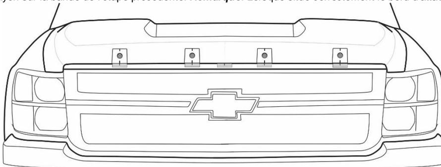
5. Scotcher temporairement les socles à la surface de la hotte dans leurs positions déterminées. Confirmez placement correct en plaçant la protection de la hotte au-dessus des quatre socles. Lorsqu'il est positionné correctement les quatre (4) trous dans la zone centrale du protecteur seront aligner avec les trous dans les chevilles. Régler si nécessaire et reconfirmer les emplacements de piédestal en utilisant les mesures de l'illustration et le protecteur de la hotte.
