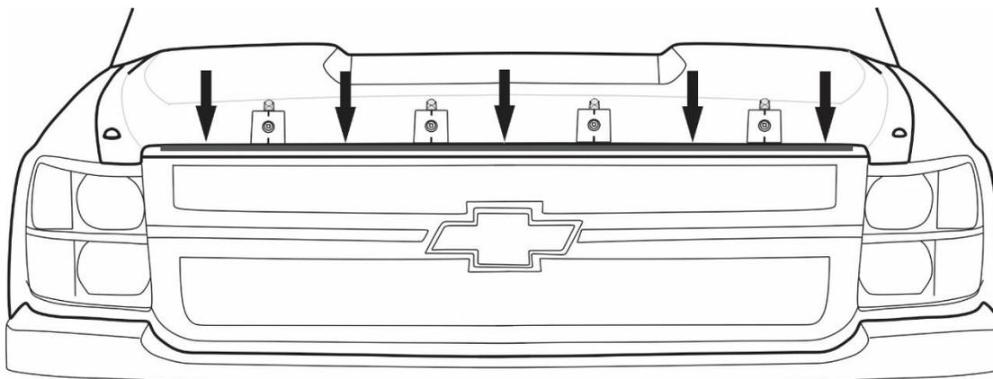
11. Placez le capot de protection sur le capot et serrez les quatre (4) # 8 x 7/16 "vis à tête de tranche à travers le protecteur et dans les chevilles. Ne pas trop serrer.
