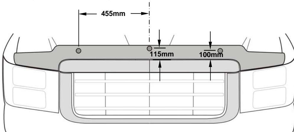
9. Placez le capot protecteur sur le capot et fixez-le (4) n° 8 x 7/16 po. treillis vis à tête à travers le protecteur et à l'expansion des bouchons. **Ne pas trop serrer.**
