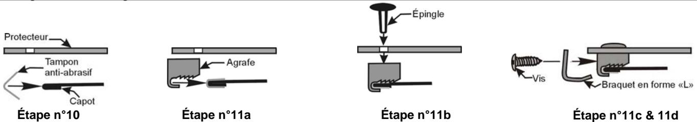
12. Sur certains véhicules, il peut être nécessaire d'ajuster les butées de capot et/ ou la fermeture du capot pour obtenir un bon dégagement. **Important: Ne jamais se servir du protecteur pour ouvrir ou fermer le capot.**
