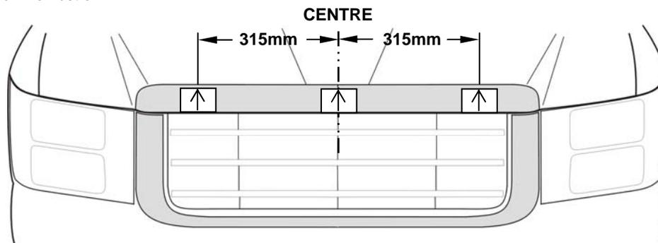
4. Installez le bouchon d'expansion se branche sur le haut du dos adhésif piédestaux. Utilisez le centrage encoche sur le piédestaux de l'aligner sur la position de la marque de crayon sur la bande lors de la précédente étape.
