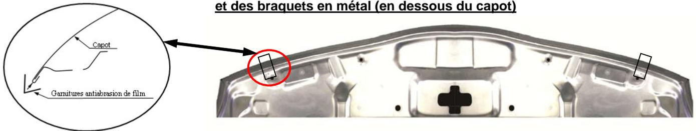
5. Installez les parenthèses en métal au-dessus du bord de capot dans leurs positions correctes. Alignez le trou dans la jambe inférieure de la parenthèse avec le trou rond dans le capot.
